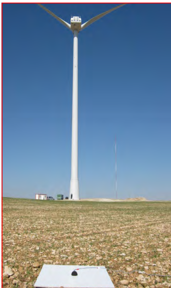
Mesura de potència acústica segons IEC 61400 part 11
