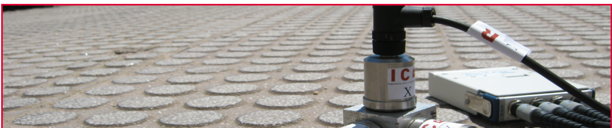
Estudio de vibraciones para evaluar la integridad de un edificio cercano a las obras.
