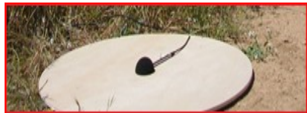
Medida de potencia acústica según IEC 61400 parte 11
