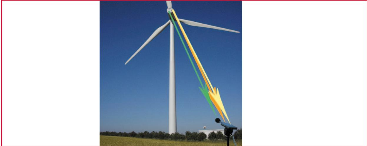
Contribución de dos bocas de ventilación y la estructura en el ruido producido por un aerogenerador.
